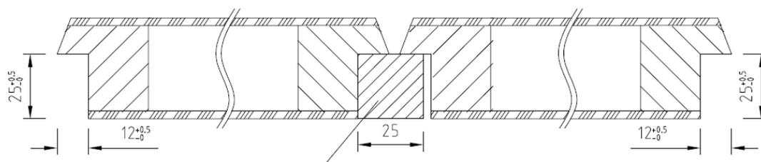
Double vantaux à recouvrements , latte
